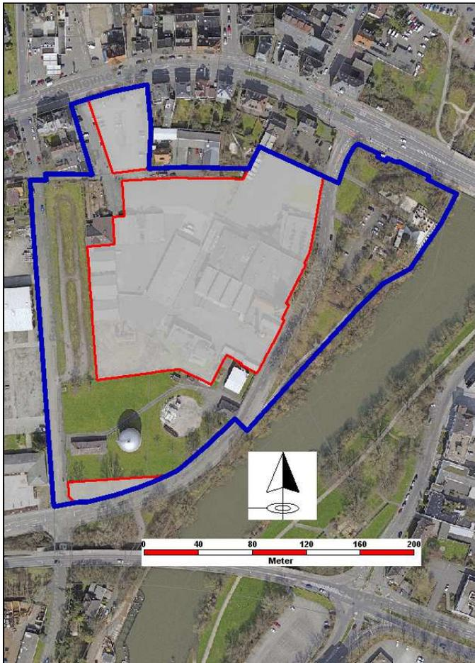
Abb: 13. Flächen, die im Geltungsbereich des Bebauungsplanes GI 54 „Hessenhalle“ 2. Änderung gemäß § 9 Abs. 5 Nr. 3 BauGB als „Flächen, deren Böden erheblich mit umweltgefährdenden Stoffen belastet sind“ zu kennzeichnen sind
