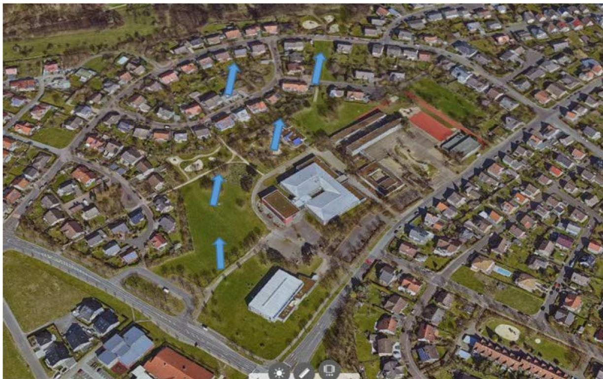
Abb. 10: Schrägluftbild nach Norden mit Darstellung der Kaltluftströmung (blaue Pfeile)
