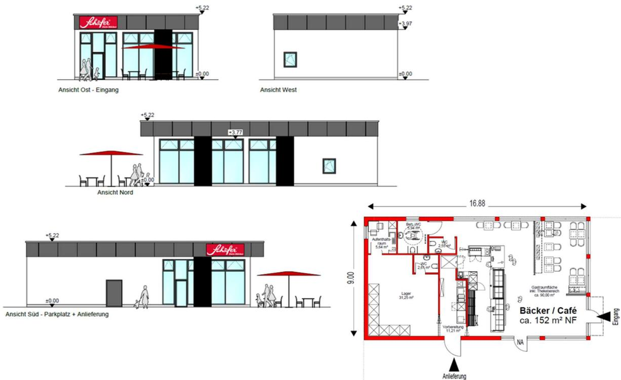
Abbildung 14: Ansichten und Grundriss des geplanten Bäckerei-Shops mit Cafébereich (Norma, 27.02.2024)
