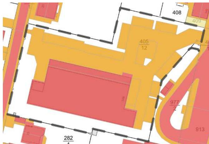
Abbildung 10: Versiegelte Flächen im Plangebiet, rot = voll versiegelte Dachflächen, orange = stark versiegelte und ggf. schmutzige Flächen (MWB)
