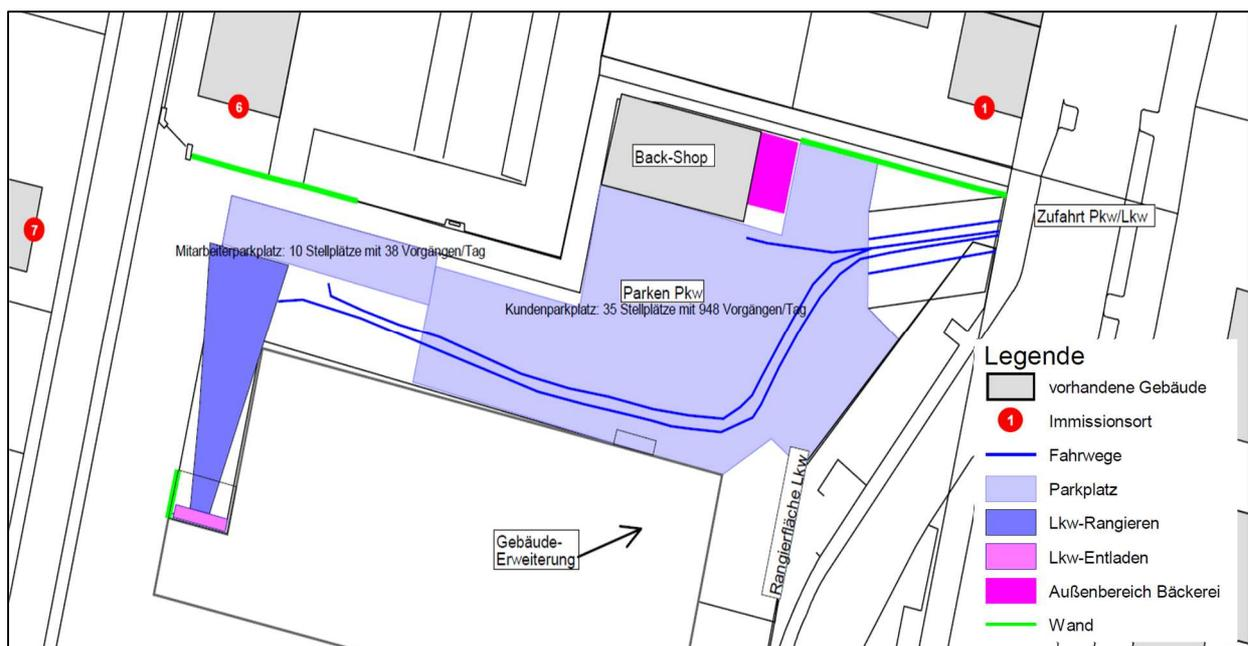
Abbildung 11: Übersichtsplan mit Lage der Schallquelle und Immissionsorte (Krebs+Kiefer, Schalltechnische Untersuchung, 04.11.2024)
