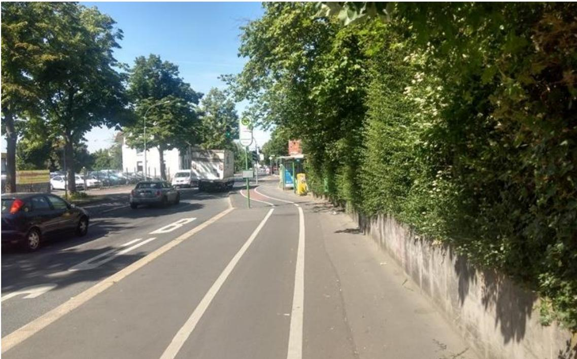
Abbildung 5: Beispiele aus Stuttgart (links) und Dortmund (rechts) für eine klare Trennung zwischen Fuß- und Radverkehr im Seitenraum
