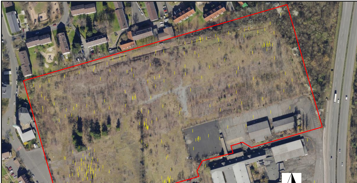
Abbildung 10-1: Bebauungsplan GI 03/17 „Ehem. Motorpool-Gelände“ – gemäß § 9 Abs. 5 Nr. 3 BauGB als „Flächen, deren Böden erheblich mit umweltgefährdenden Stoffen belastet sind“ zu kennzeichnende Fläche (rot) und Lage der bekannten Sondierungen (gelb), Orthophoto 2014.
