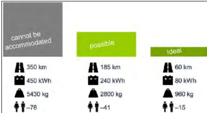
Abbildung 3-7: Batteriebus-Konfigurationen: Bewertung durch den Weltverband der Verkehrsunternehmen UITP (Quelle: UITP, 2017)
