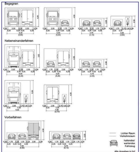
Bild 17: Beispiele für Verkehrsraum und Lichter Räume beim Begegnen, Nebeneinander- und Vorbefahren ausgewählter Kombinationen von Bemessungsfahrzeugen (Klammern mit eingeschränkten Bewegungsspielräumen)
