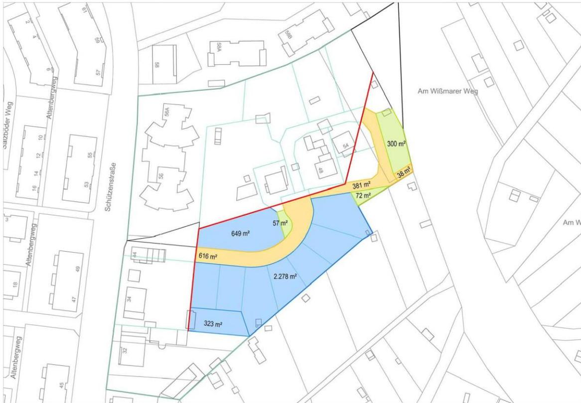
Abb. 6: Bauflächen und Erschließungsflächen, denen Ausgleichsmaßnahmen zugeordnet werden
