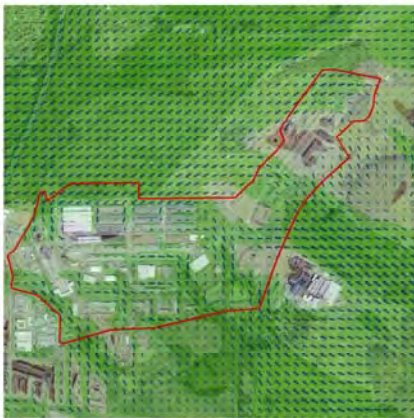
Das bodennahe Strömungsfeld (Pfeile) und der Kaltluftvolumenstrom (Farbe) heben die Bedeutung der Planfläche als Durchtrittsbereich für Kaltluftströmungen Richtung Wiesseckau hervor.
